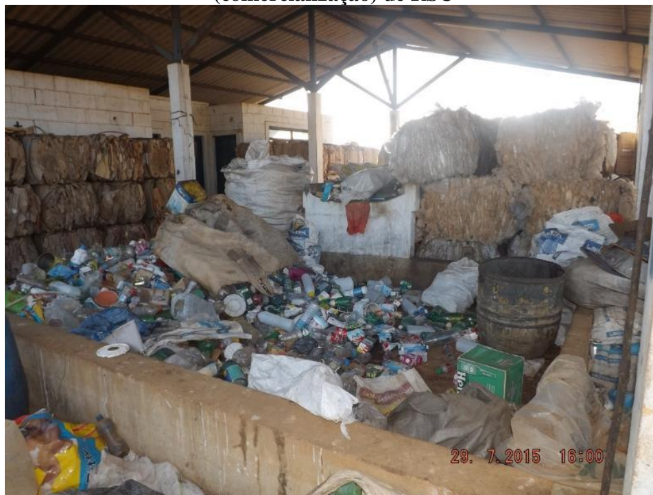
Figura 96 – Aspecto interno da UTC onde percebe-se espaço reduzido para segregação dos RSU indicando a necessidade de otimizar o fluxo de entrada e saída (comercialização) de RSU
